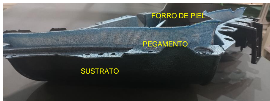
Ilustración 7: Diagrama esquemático de una de las partes de wrapping ya aplicada.
