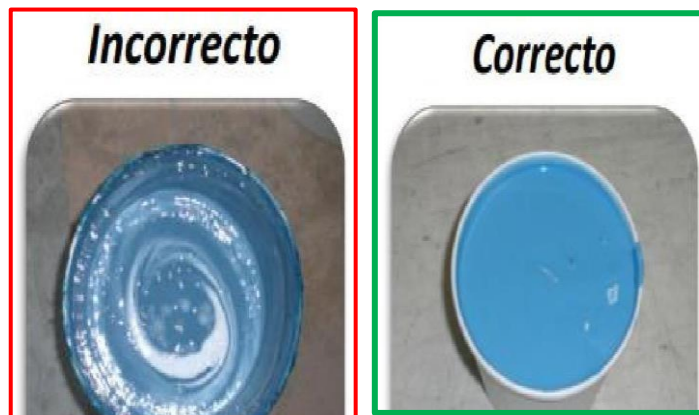
Ilustración 10: Ilustración 10. Calidad de mezcla.
