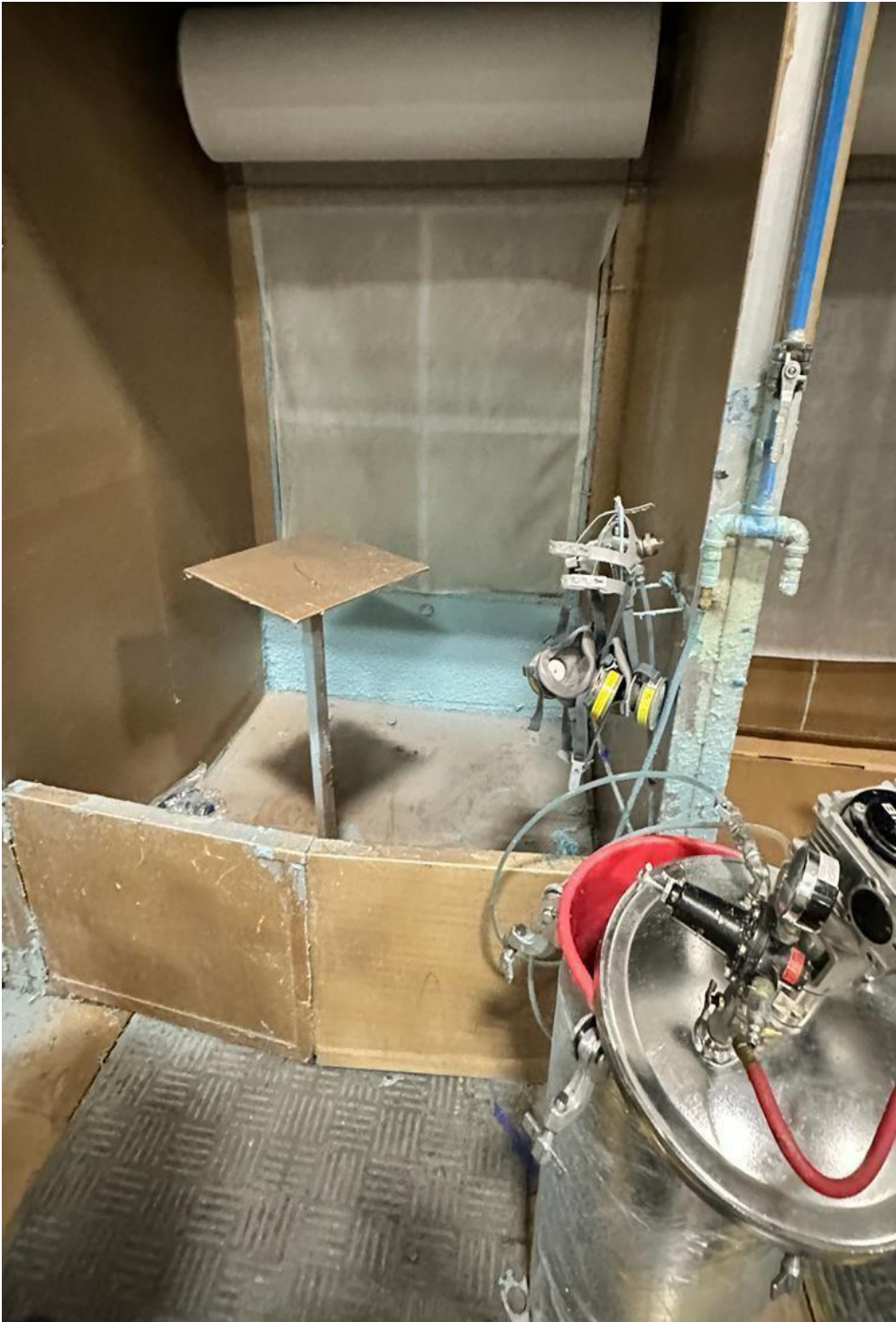
Ilustración 36: Cabina de aplicación de pegamento.
