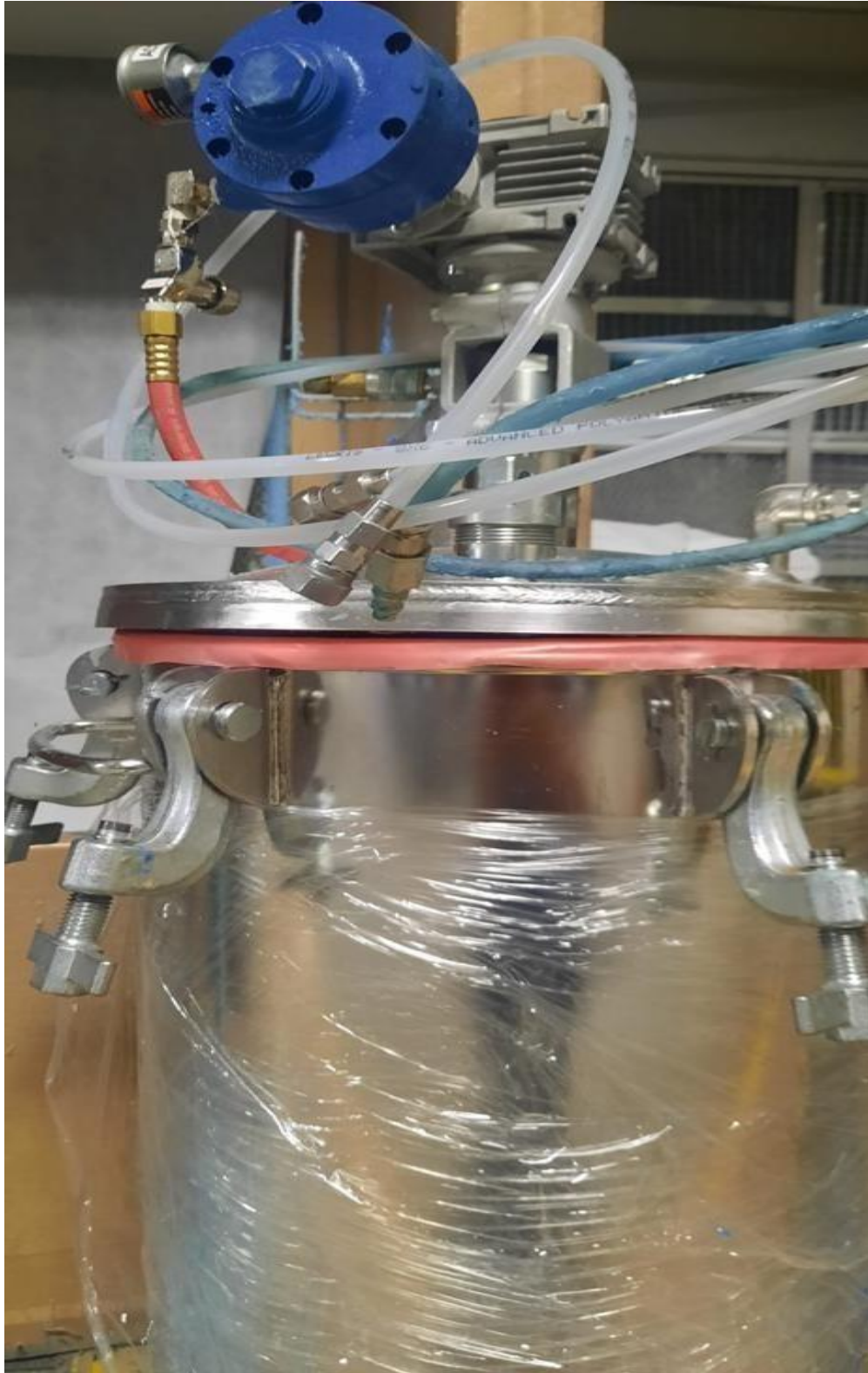
Ilustración 35: Estación de limpieza de pistolas. Fuente: Elaboración propia
